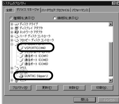
「ポート (COM / LPT)」の下に「VSPORT (COM4)」(システムによっては、COMの番号が変わります)と、「モデム」の下に「SUNTAC Slipper U」が表示されていればインストールは完了しています。
