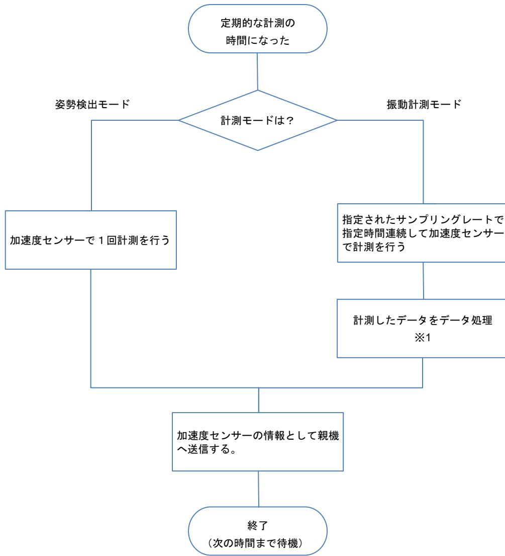
※1 振動計測モードでは、計測した全データから加速度値の大きなもの上位から指定した範囲分を対象として平均値を計算します。
