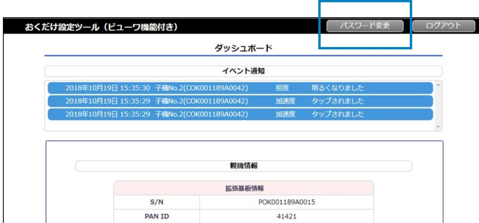
2. パスワード変更画面が表示されます。現在のパスワードを入力した後、新しいパスワードを入力します。
