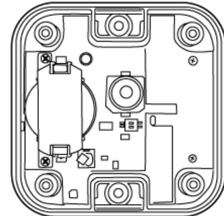
3. 電池保護カバーの開閉ネジ（2箇所）を取り外し、電池保護カバーを外します。
