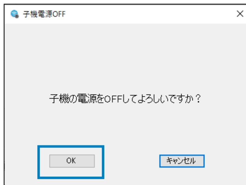
3. 子機の電源が切斷されます。このとき、子機のLED状態ランプが5回赤色点滅するのを確認してください。
