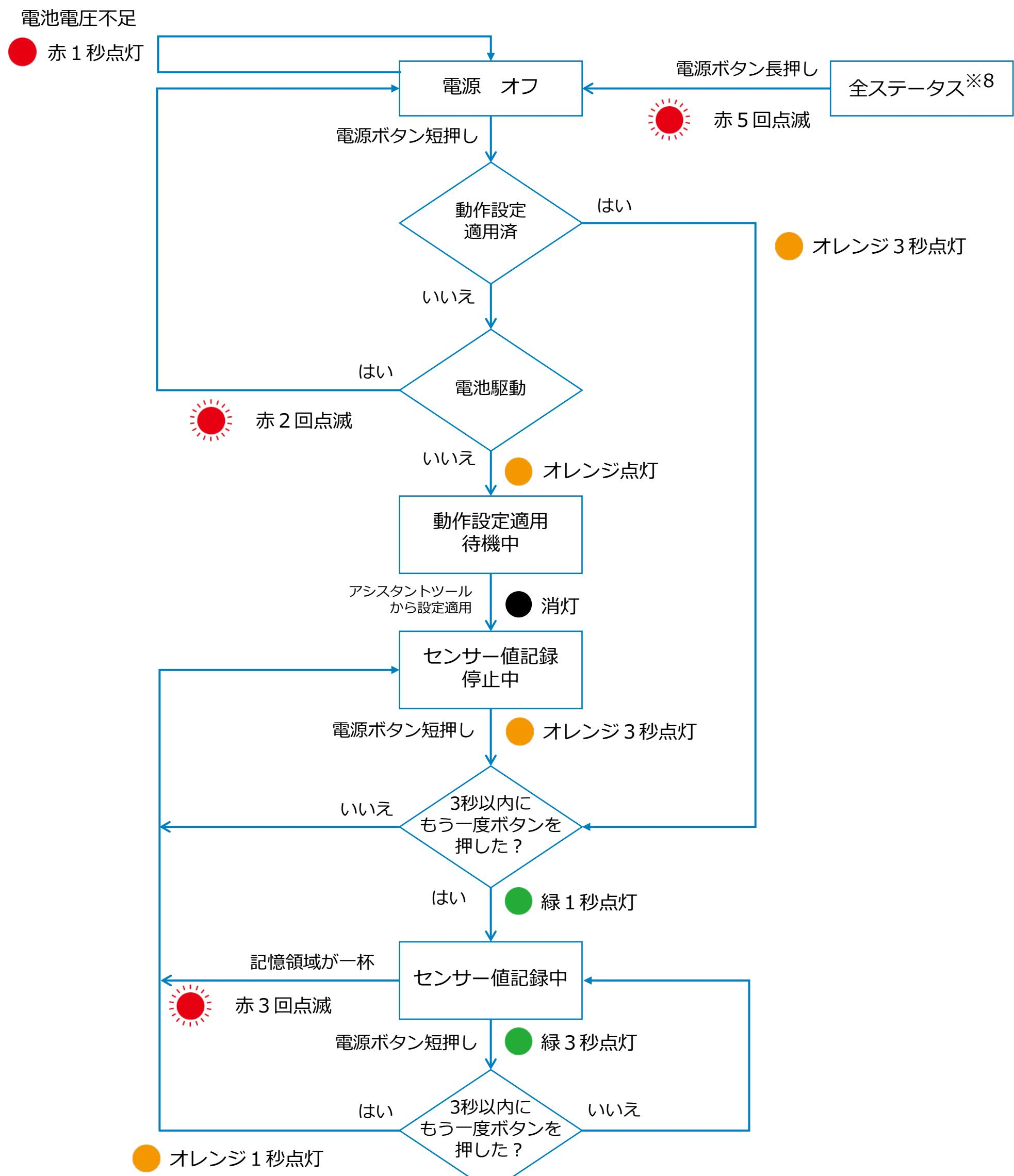
※8 「動作設定適用待機中」「センサー値記録停止中」「センサー値記録中」において電源ボタン長押し
