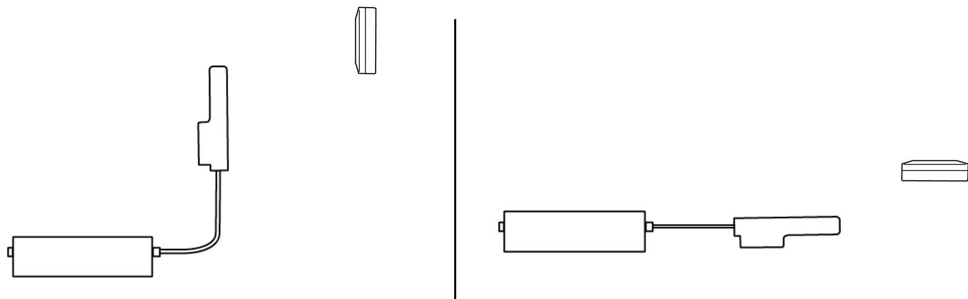
MOBILE1・2アンテナコネクタに接続したアンテナは、垂直になるように固定してください。
