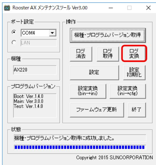
3. 「ファイルを開く」ウィンドウが表示されますので、ログファイル(binファイル)を選択し、[開く]ボタンを押します。
