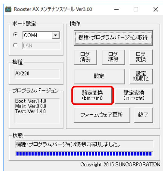
3. 「ファイルを開く」ウィンドウが表示されますので、設定ファイル (bin ファイル) を選択し、[開く] ボタンを押します。
