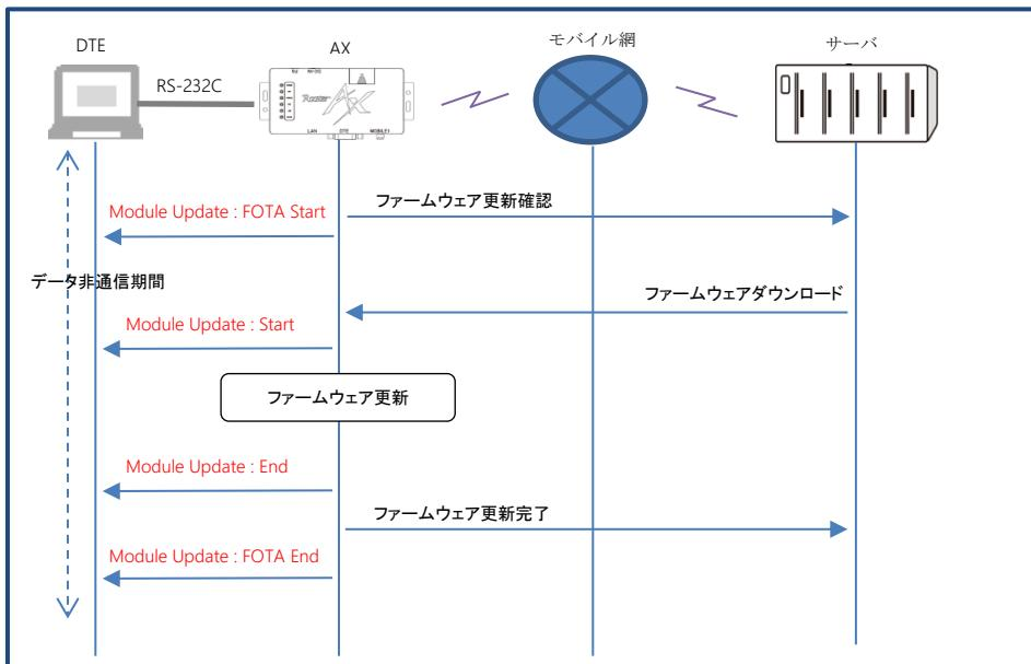
**!** AT コマンド互換通信モード(モデム接続・プロコン接続)の場合は、FOTA 中に制限があります。
