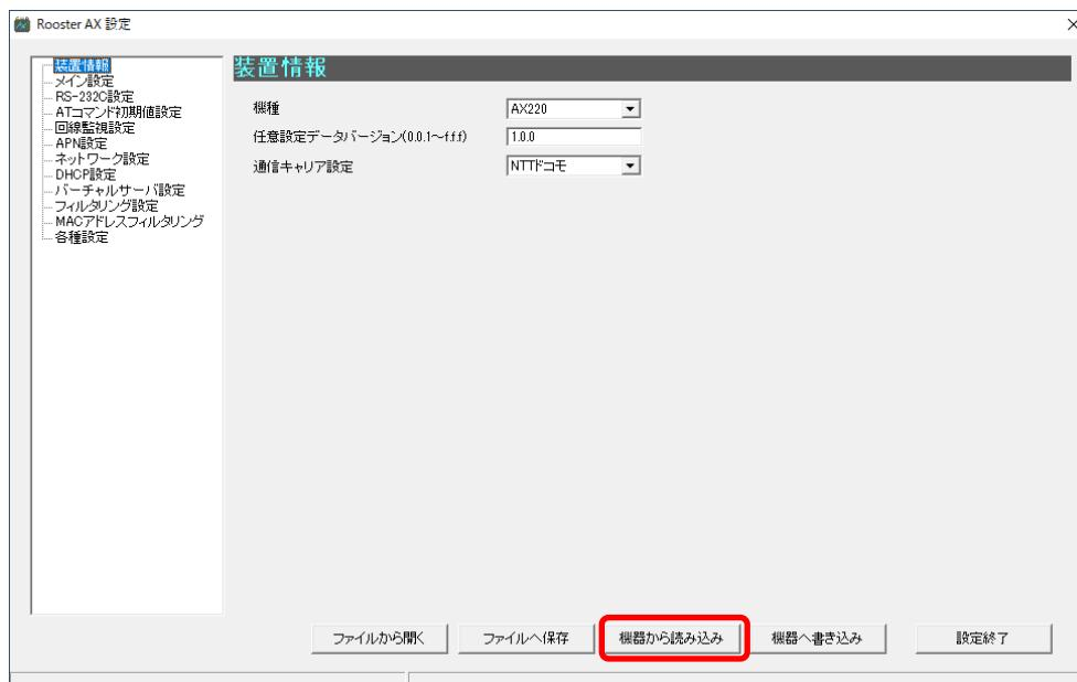
4. 読み込みが完了すると、「設定データ読み込みに成功しました。」と表示されます。
