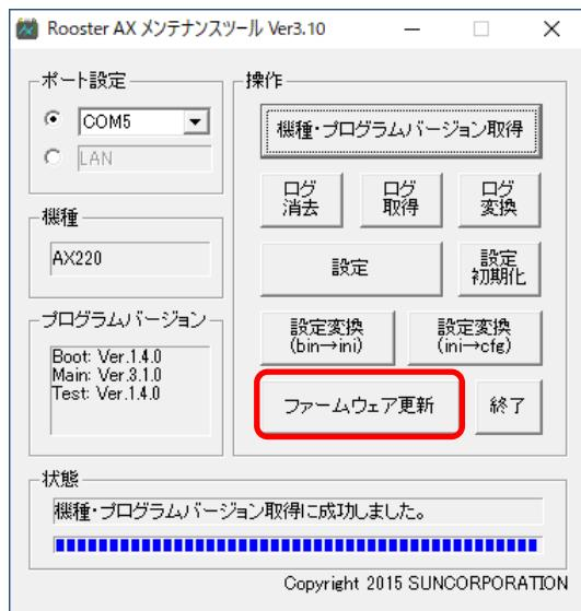
3. 「ファイルを開く」ウィンドウが表示されますので、ダウンロードしたファームウェアファイルを選択し、[開く] ボタンを押します。
