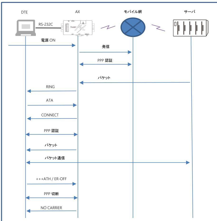
プロコン通信モード・AT コマンド互換通信モード(プロコン接続)での IP 着信動作の例は以下の通りです。
