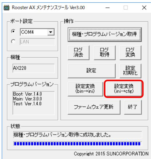
3. 「ファイルを開く」ウィンドウが表示されますので、設定ファイル（ini ファイル）を選択し、[開く] ボタンを押します。
