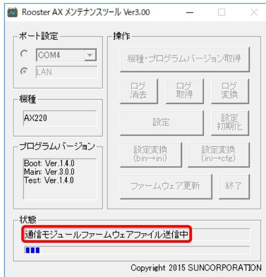
5. ファームウェアファイル送信が完了すると確認ウィンドウが表示されますので、[OK] ボタンを押します。
