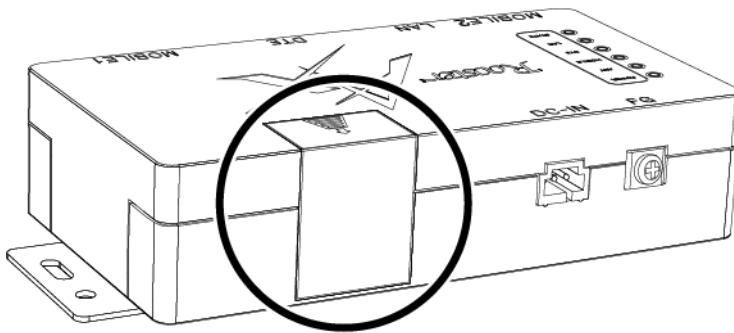
2. SIMカードをSIMカードソケットに挿入します。
