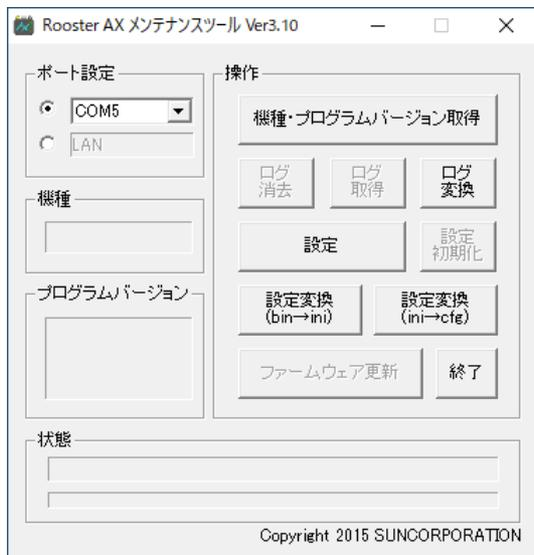
2. RS-232C 設定モードの場合は、「ポート設定」項目のラジオボタンで COM を選択し、本製品と接続している PC の COM ポートの番号をプルダウンメニューから選択します。
