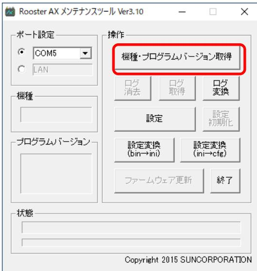
5. 「機種」項目に機種名、「プログラムバージョン」項目にバージョンが出力されることを確認します。出力が表示されたら、正常に接続されています。
