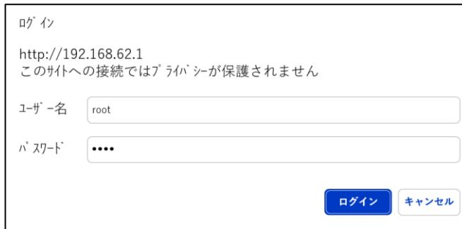
3. ユーザー名に「root」、パスワードに「root」（工場出荷時状態）と入力した後、[OK] ボタンをクリックします。
