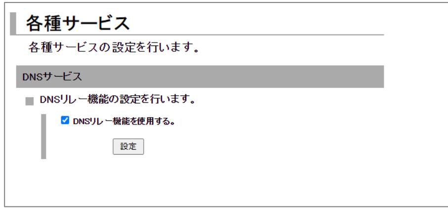
2. DNSリレー機能を使用する場合、【DNSリレー機能を使用する】チェックをオンにします。
