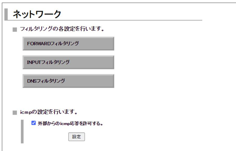
2. 外部からの ICMP に応答させない場合、「外部からの icmp 応答を許可する」のチェックをオフにします。
