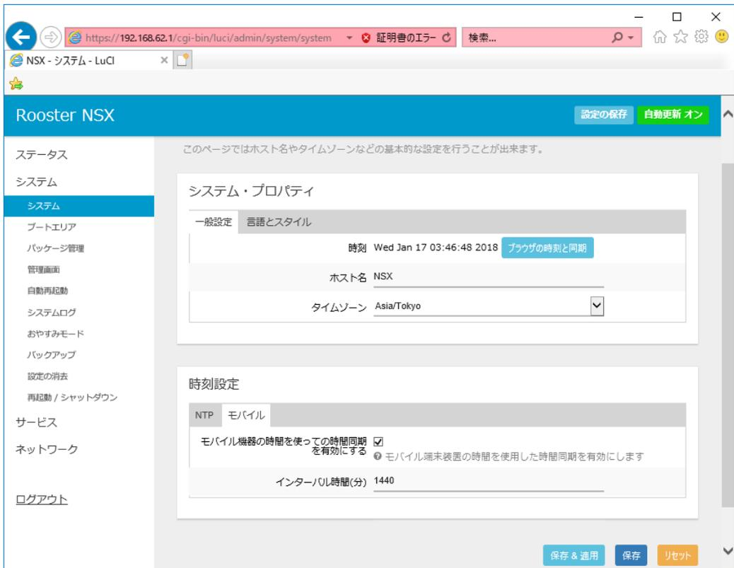
3. 設定をシステムに反映するために「保存&適用」ボタンをクリックします。システムに設定が反映されると、自動的に時刻を同期します。
