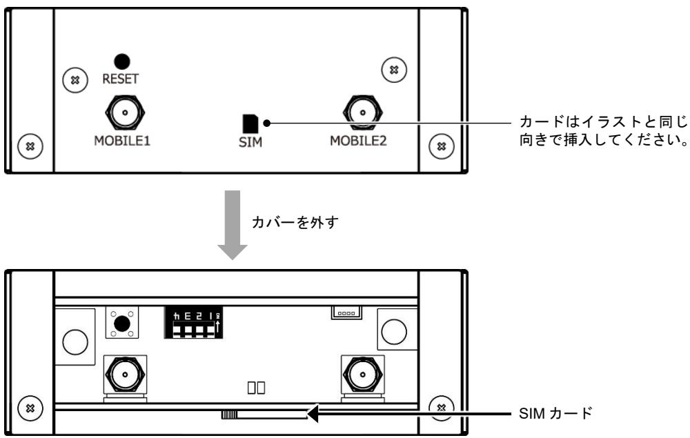
1. SIM カード挿入口ネジを外し、カバーを外します。
