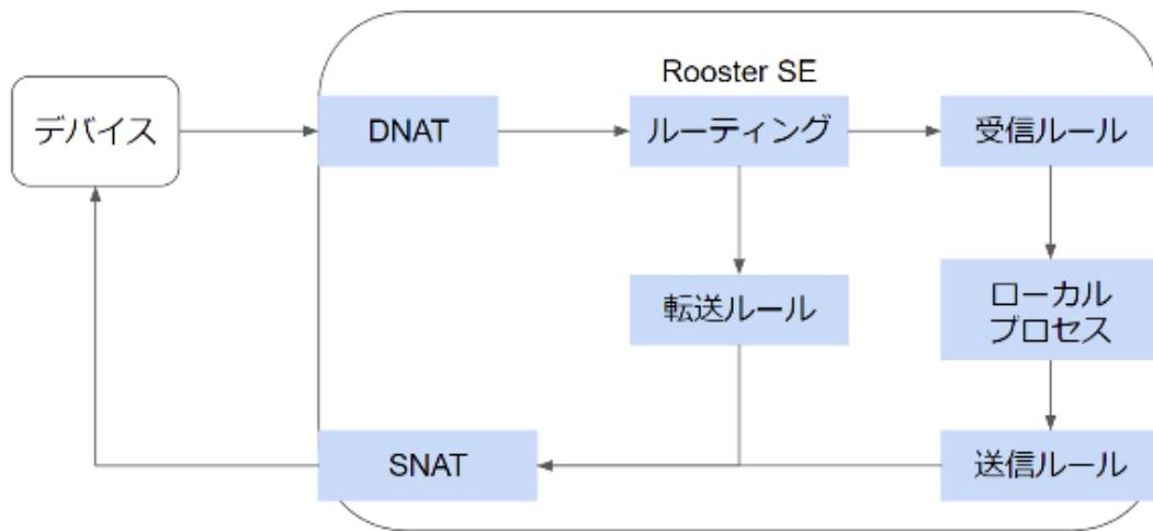
図 7-3-1 パケット処理の流れ
